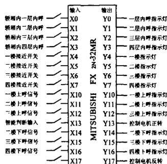
图 2 输入/输出点的地址分配图
